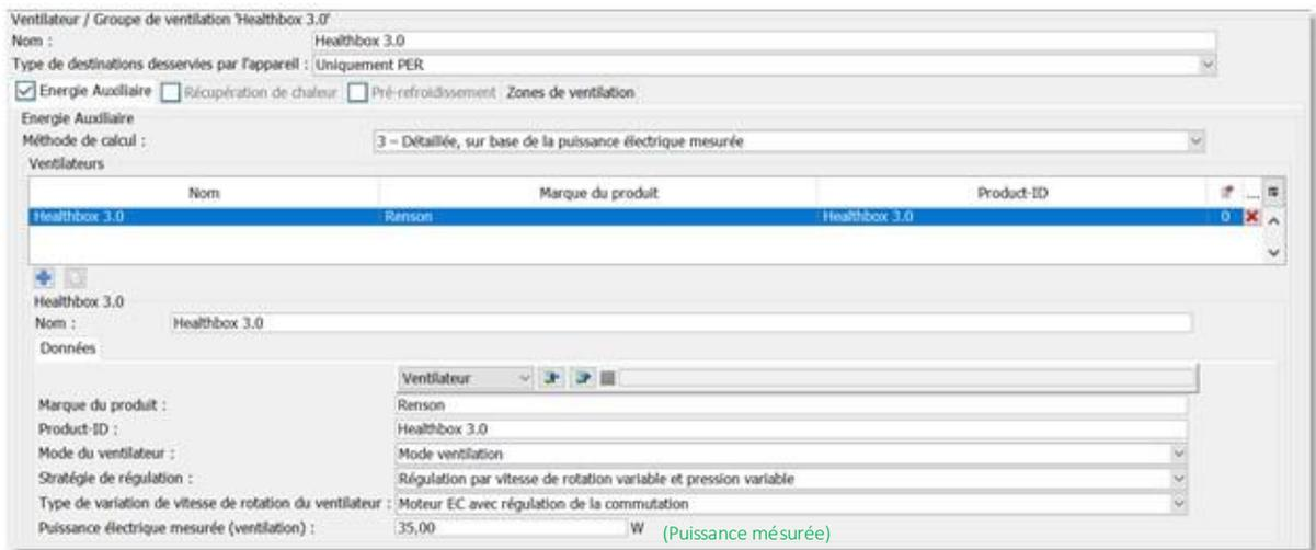
Pour le Waves, choisissez de préférence la méthode de calcul '2 – Détaillée, sur base de la puissance électrique mesurée'. Le Waves est un ventilateur local et il est donc généralement soumis à une pression proche de son maximum. Il y aura donc peu de différence entre la puissance maximale de 5 W et la puissance mesurée. Par conséquent, l'impact sur le niveau Ew résultant sera négligeable.
