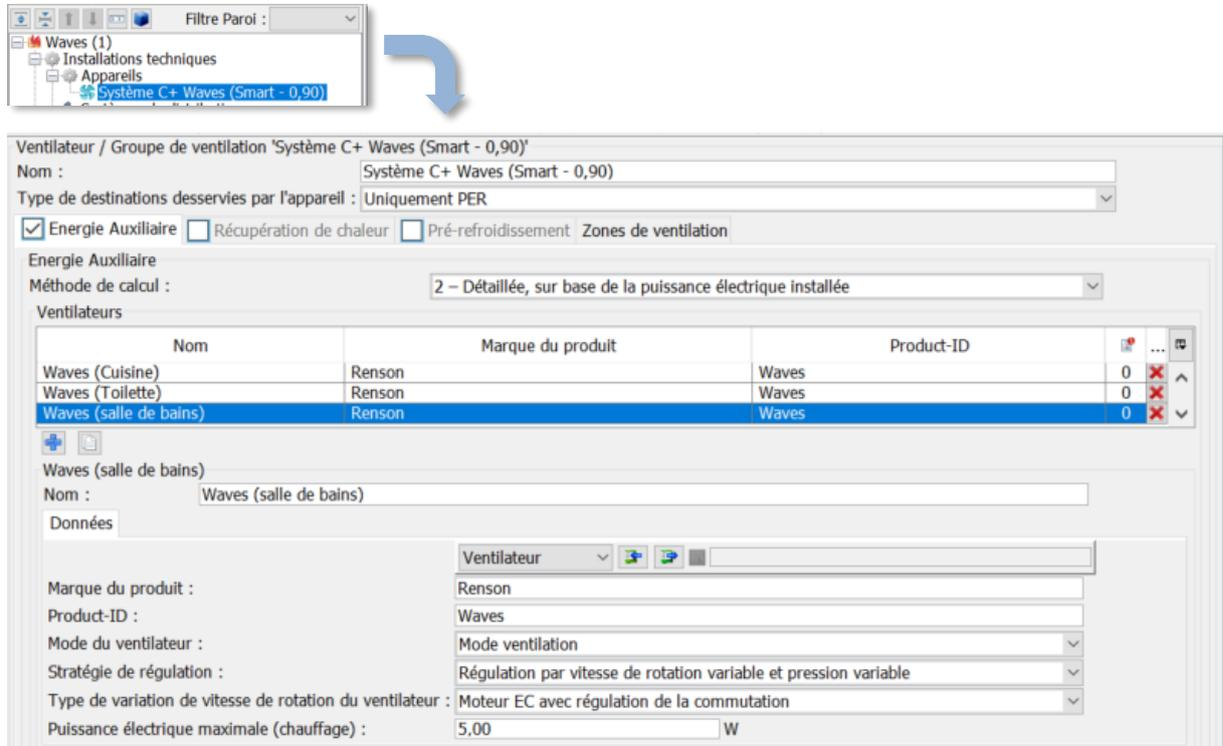
On peut aussi choisir de mesurer efficacement la puissance de Waves (méthode 3). Mais compte tenu de la faible puissance installée de Waves, l'avantage supplémentaire tiré de la mesure de la puissance est limité et n'a donc pas lieu d'être.
