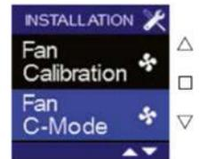
d. Sélectionnez le '**C-mode**' avec la touche **□**. 'C-mode' s'allume et l'unité de ventilation fonctionne maintenant en mode C;
