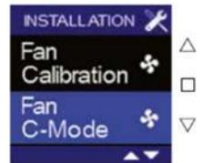
d. Sélectionnez le '**C-mode**' avec la touche **□**. 'C-mode' s'allume et l'unité de ventilation fonctionne maintenant en mode C;
